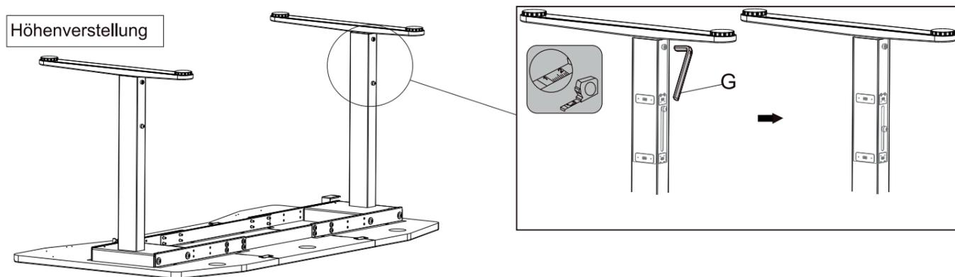
Stellen Sie die gewünschte Länge der Tischbeine ein, bevor Sie den Tisch aufstellen. Lösen Sie die Schrauben mit dem Inbusschlüssel (G) und ziehen Sie anschließend an den Standfüßen, um die Höhe einzustellen. Ein Maßband wird empfohlen, um sicherzustellen, dass die Tischbeine die gleiche Länge haben.
