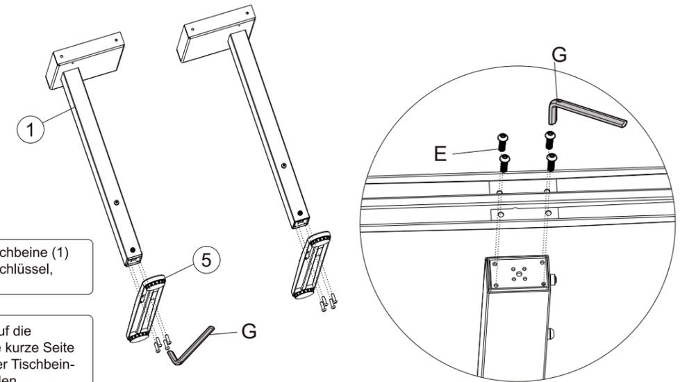
Montieren Sie die Standfüße (5) und Tischbeine (1) miteinander. Nutzen Sie den 4x4 Inbusschlüssel, um die Schrauben (A) festzuziehen.
