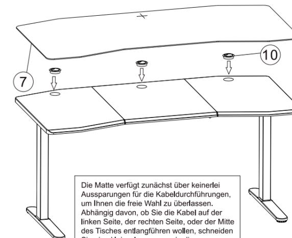
Die Matte verfügt zunächst über keinerlei Aussparungen für die Kabeldurchführungen, um Ihnen die freie Wahl zu überlassen. Abhängig davon, ob Sie die Kabel auf der linken Seite, der rechten Seite, oder der Mitte des Tisches entlangführen wollen, schneiden Sie eine kleine Aussparung in die entsprechende Stelle.
